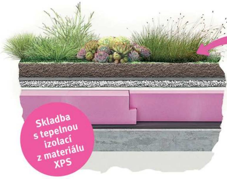
Skladba s tepelnou izolací z materiálu XPS
